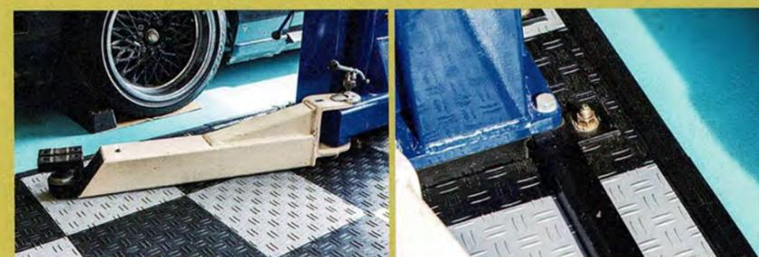
タイルを敷いたことでリフトのアームの高さと床の距離が短くなり、車高の低いクルマもリフトに載せられるように。リフトの根元部分のタイルは、形状に合わせてHさん自身が加工。
