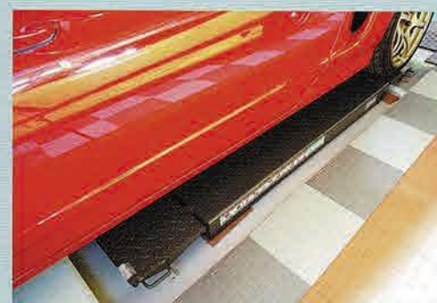
SKTOKI製の油圧式センサーリフトを設置。リフトの導入はガレージの設計時から視野に入れていた。
